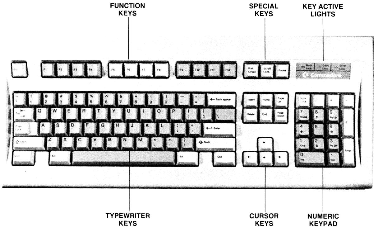
**FIGURE D-1. THE COMMODORE PC40-III KEYBOARD**
